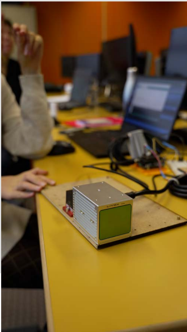
FIGURE 2 – Travaux pratiques dans le cadre du module SMC (Systèmes de mesures cinématiques) : programmation d'un LiDAR Livox
